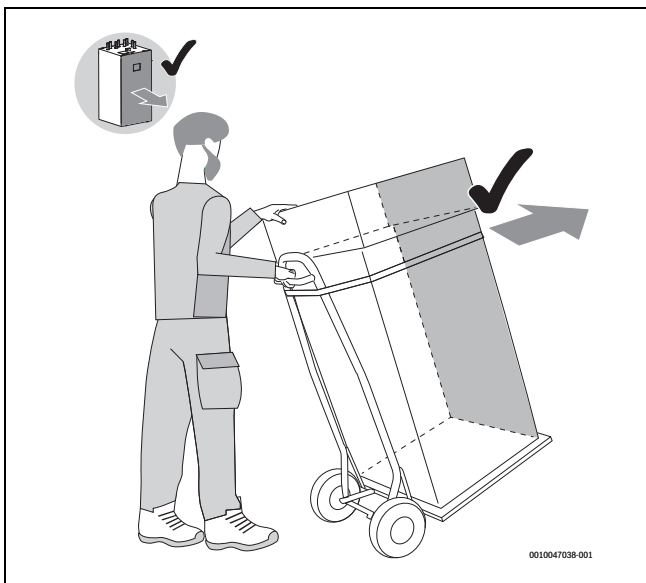
Bild 9 Inneneinheit mit einer Sackkarre transportieren
