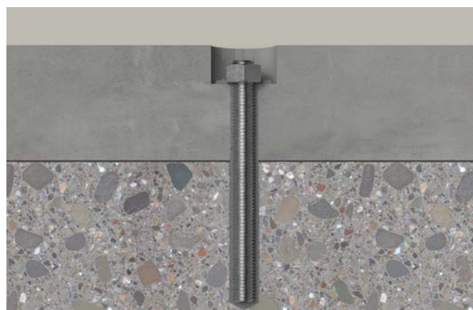
Brückenkappenanker FCC-B zur Verankerung von Betonfertigteilen
