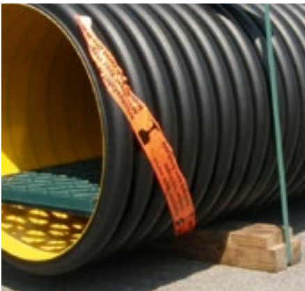
Lagerung auf Lagerhölzern
