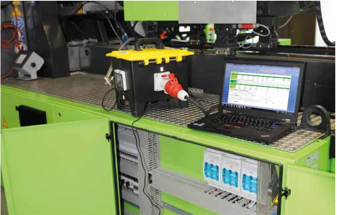
Messen über Maschinezuleitung mit Rogowski-Spulensatz
