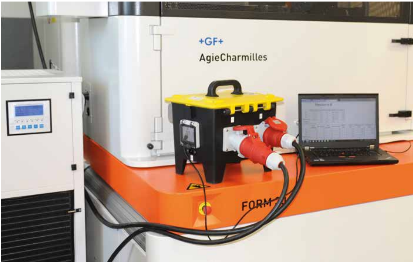
Messen über Maschinentzuleitung mit 16A, 32A oder 63A CEE-Anschlussstechnik
