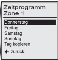
Durch weiteres drehen des rechten Drehknopfs „Kopieren Tag“ anwählen, und durch erneutes drücken die Auswahl bestätigen. Es wird automatisch in den Kopierbereich gewechselt.
