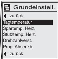
Tagtemperatur mit rechtem Drehknopf auswählen und bestätigen. Durch Drehen des rechten Drehknopfes gewünschte Temperatur einstellen und anschließend bestätigen.
