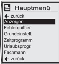
Rechten Drehknopf drücken um in die 2. Bedienebene zu wechseln. Durch Drehen des rechten Drehknopfs im Uhrzeigersinn die Menüebene „Anzeigen“ anwählen und durch erneutes drücken des rechten Drehknopfs die Auswahl bestätigen.
