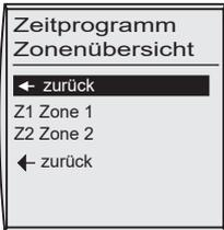
Rechten Drehknopf drücken um in die 2. Bedienebene zu wechseln. Durch drehen des rechten Drehknopfs im Uhrzeigersinn die Menüebene „Zeitprogramm“ anwählen und durch erneutes drücken des rechten Drehknopfs die Auswahl bestätigen.
